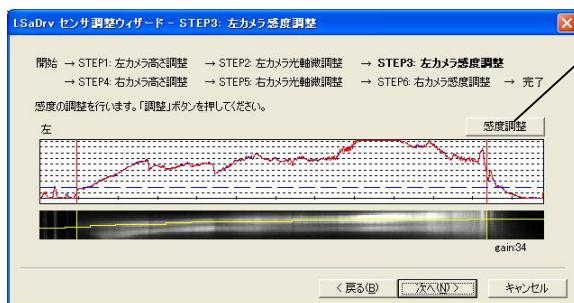
感度調整：エラー表示があつたり、波形の一部でも青い破線より下側にあつたり、波形が飽和して上部に張り付いている場合は「感度調整」ボタンをクリックしてください。
