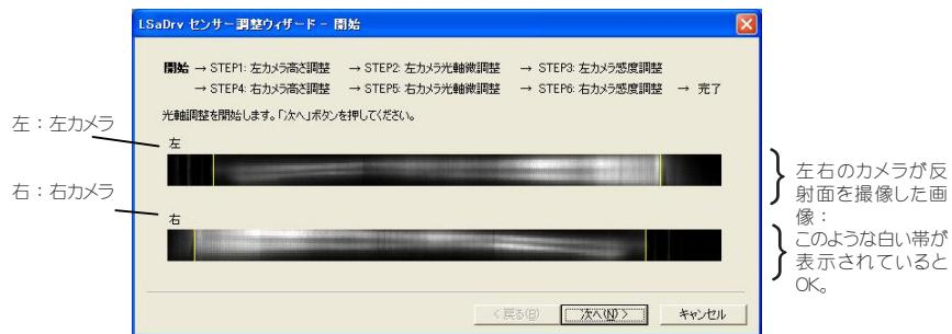
タッチ面や反射面に障害物があるか、センサーカメラの光軸調整が合ってない場合は下記のようなエラーメッセージを表示しますので、「次へ」をクリックして問題を解決してください。
