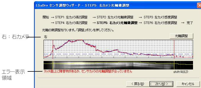
} 下の撮像画面に表示されている黄色い横線上の画像の明るさを波形データで表示した画面。
